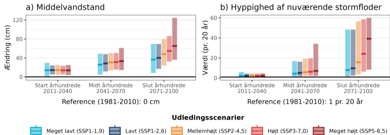
Figur 10. Fremtidens a) ændring i middelvandstand ift. referenceperioden 1981-2010 og b) hyppigheden af en nuværende 20-års stormfod for Lillebælt sydlig under forskellige udledningsscenarier. Den sorte linje viser værdien for referenceperioden (1981-2010). Bemærk også at denne indikator maksimalt viser 60 stormfloder per 20 år, selv hvis de beregnede værdier bliver endnu højere.
